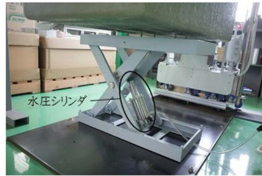
図4. 水圧シリンダを用いたテーブルリフター
