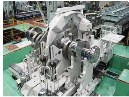
図2. 独自技術を投入して開発・導入したクランクシャフト専用加工機
