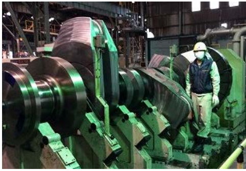
図2. 独自技術を投入して開発・導入したクランクシャフト専用加工機
