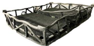
1年使用した金属製のトレイ
